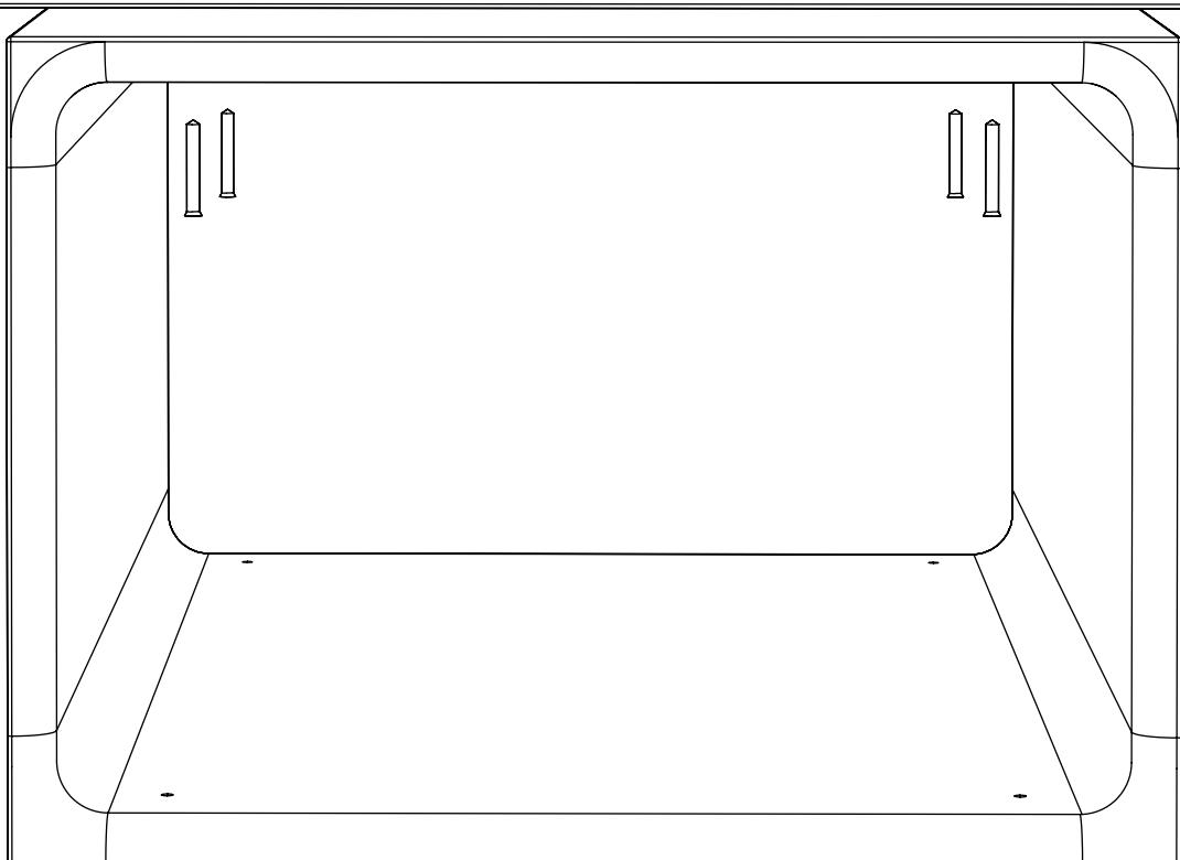
IT • INSERIRE LE VITI NEI FORI DELLA BASE INFERIORE ED AVVITARE.
